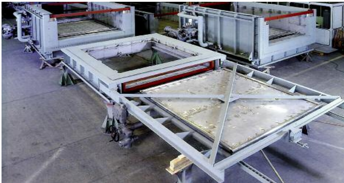
Bild oben: Absperrschieber NW 3050 x 3050 für das GUD-Kraftwerk ENTEK in der Türkei.
