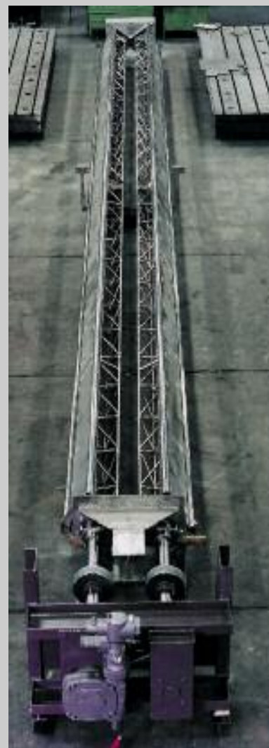
Bilder rechts und links: Absperr- und Regelsystem DBP Nenn- weite 600 x 17500 mm für das GUD-Kraft- werk Bitterfeld .
