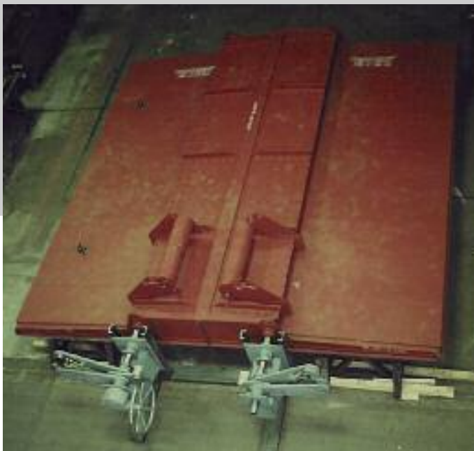
Bild oben: Kaminklappe DN 7000 mm geliefert über BALCKE-DÜRR , Austria für die Anlage KASTROE HRSG , Norwegen.
