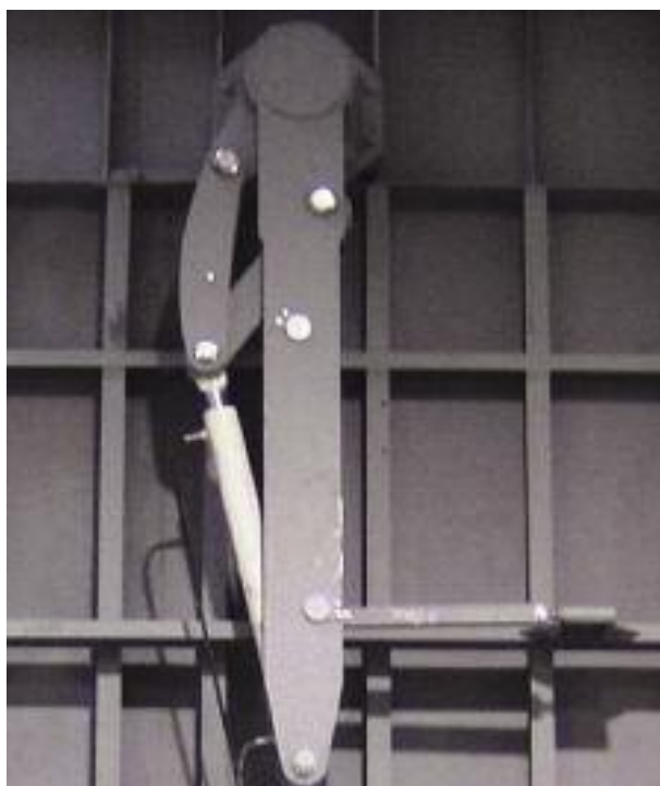
Bild unten: ZWEIHEBELANTRIEB an einem DIVERTER NW 5600 x 5600 mm
