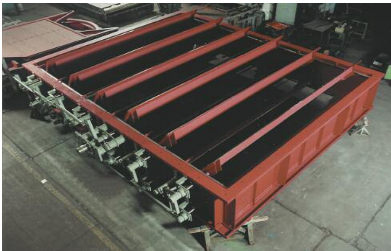
Doppel-Jalousieklappe NW 6780 x 5390 mit Dichtsystem NICROFLEX-HIPERFORM DBP und Sperrluft 100% dichtschießend nach UVV. Geliefert für das RWE-STEAG Kraftwerk Voerde , im Rahmen einer Renovierung und Modernisierung der Anlage.
