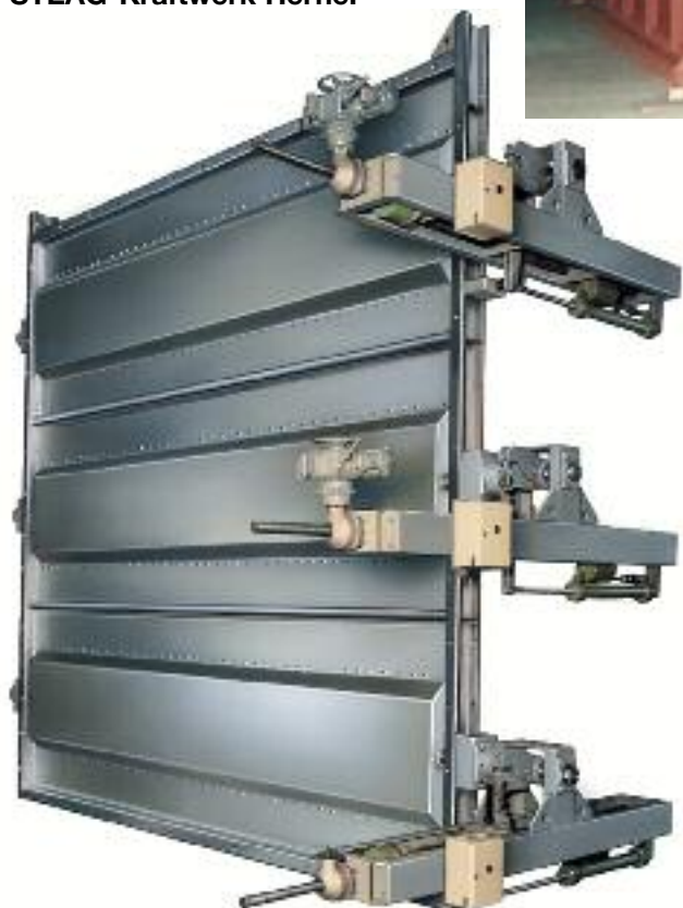
Bild oben rechts: Jalousieklappe DN 5600 mm mit Dichtsystem MICROFLEX. Auslegung: t = 400\text{ }^{\circ}\text{C} , p diff. 90 mbar Werkstoff 15 Mo 3. Geliefert für die DeNOx-Anlage im STEAG-Kraftwerk Herne.
