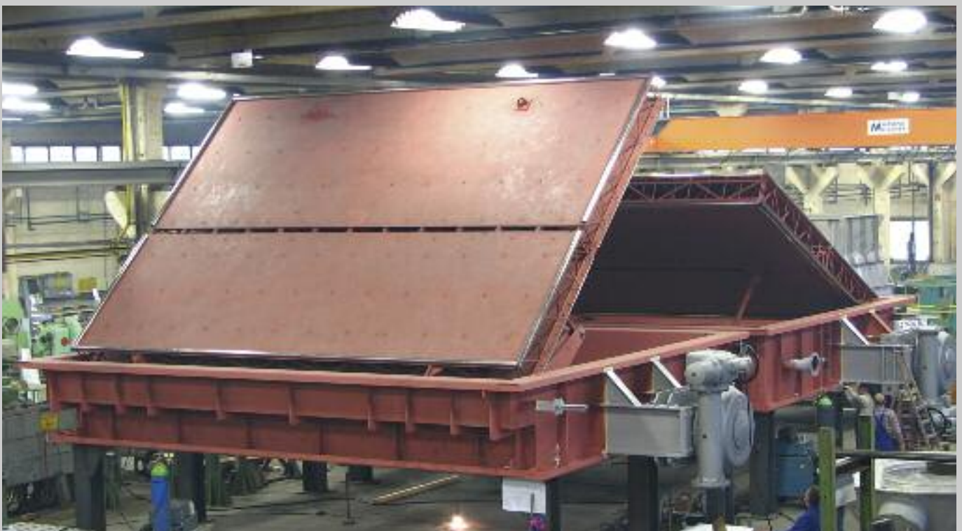
Bild unten: Zwei Gasweichen NW 7480 x 5300 mm für die DeNOx-Anlage des Kraftwerkes AMER in Holland im Werk Rauenstein. Die Komplettierung mit dem Kanalstück erfolgte auf der Baustelle.
