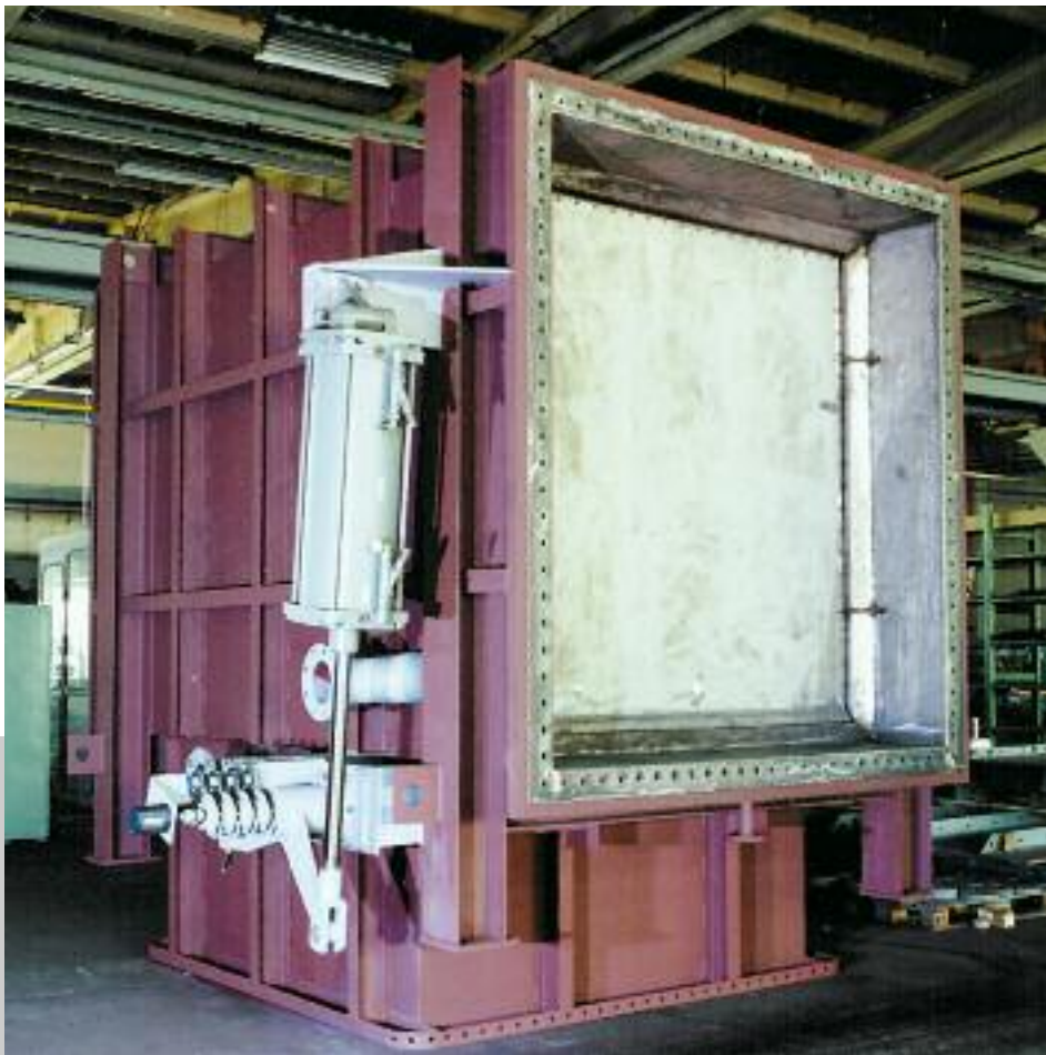
Gasweiche 4800 x 5300 mm, geliefert für die REA des Kraftwerkes WESER, Veltheim BRD.
