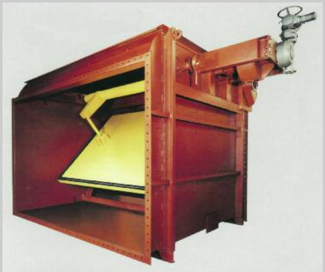
Gasweiche 4800 x 5300 mm, geliefert für die REA des Kraftwerkes WESER, Veltheim BRD.
