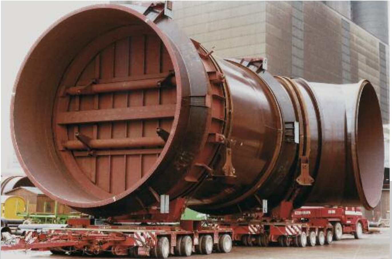
Bild unten: Zwei Gasweichen NW 7480 x 5300 mm für die DeNOx-Anlage des Kraftwerkes AMER in Holland im Werk Rauenstein. Die Komplettierung mit dem Kanalstück erfolgte auf der Baustelle.
