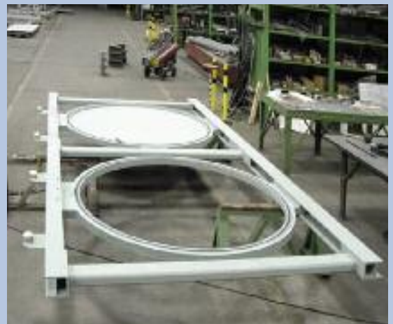
Bilder unten: Brillenschieber NW 2200, mechanisch betätigt, bei der Montage im Werk.
