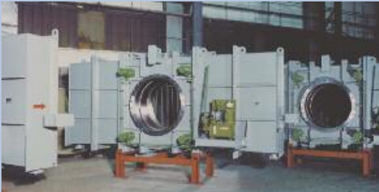
Bild oben: Brillenschieber für den Einbau in eine vertikale Rohrleitung. Die gleiche Ausführung kommt auch für den vertikalen Einbau in eine horizontale Rohrleitung zum Einsatz.
