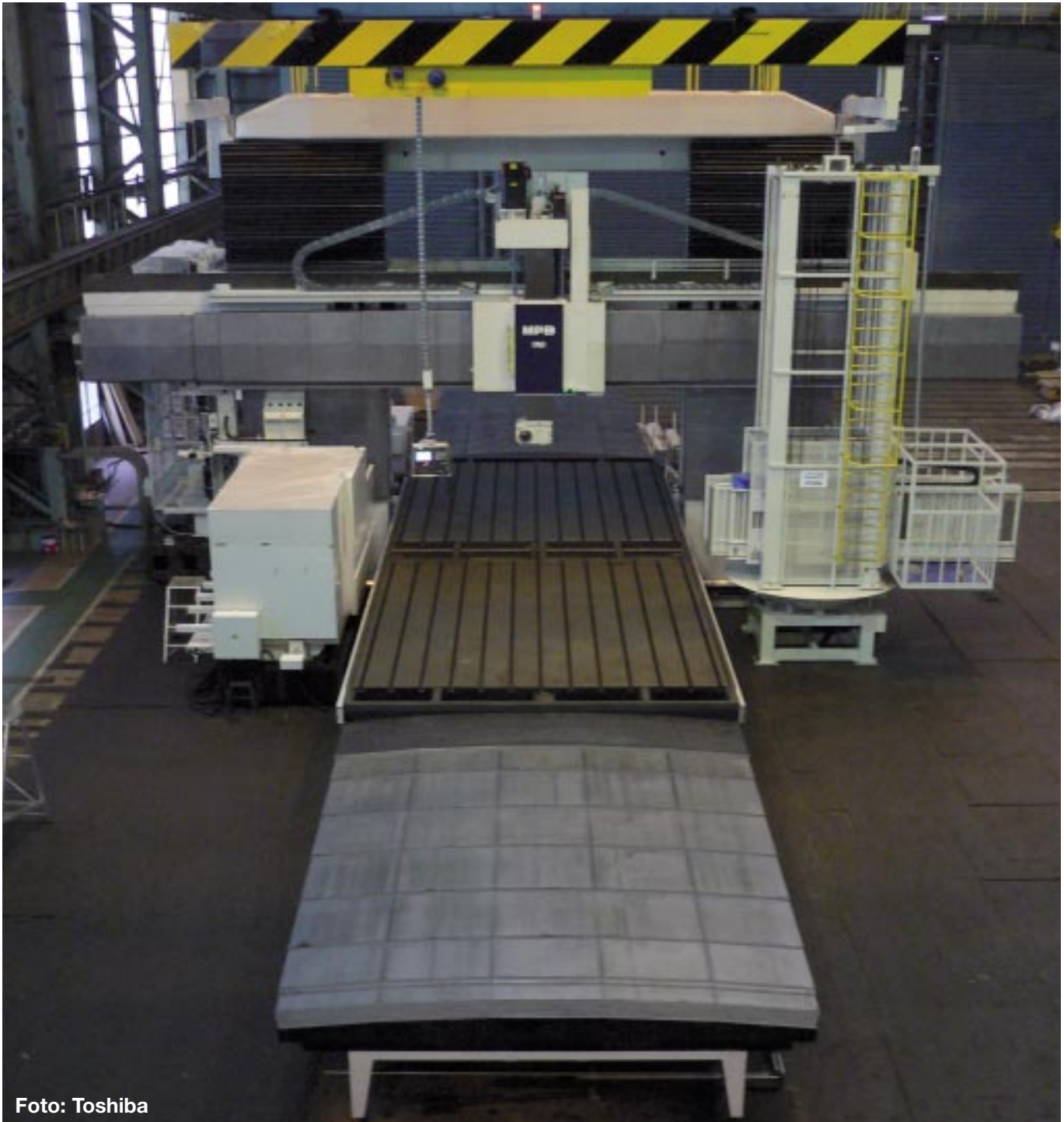
TOSHIBA-Bearbeitungs- zentrum mit Teleskopab- deckungen von RAUMAG- JANICH.
